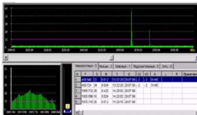
Рис. 5.2 Спектральная панорама с сигналом радиомикрофона с цифровой модуляцией
