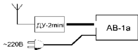
Рис. 6. Включение/выключение генераторного блока 1А с помощью "Сонаты-ДУ2mini".
