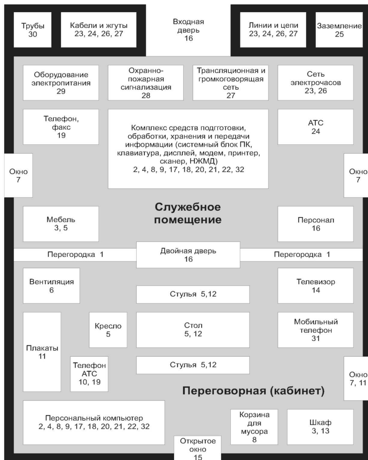
Рис. 1. Схема возможных каналов утечки и несанкционированного доступа к информации.
